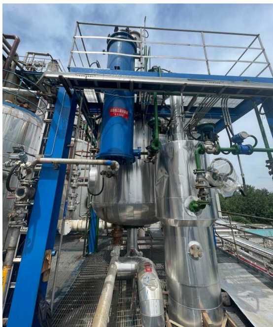
图3：邻氯苯胺蒸馏装置
