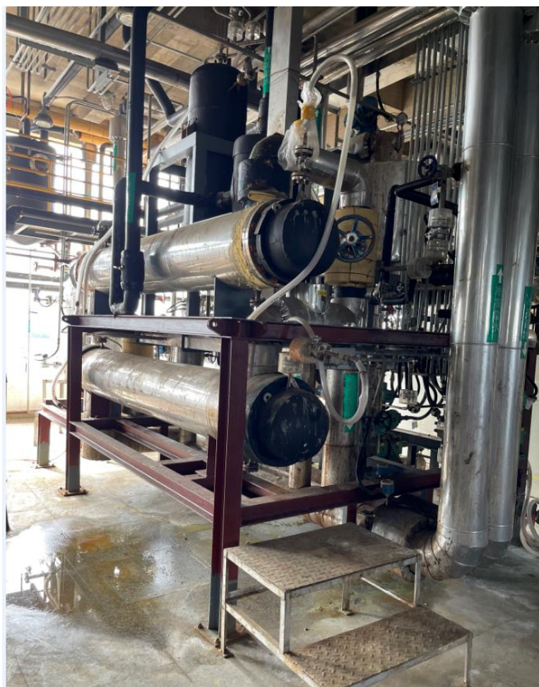
图2：车间三管式反应器
